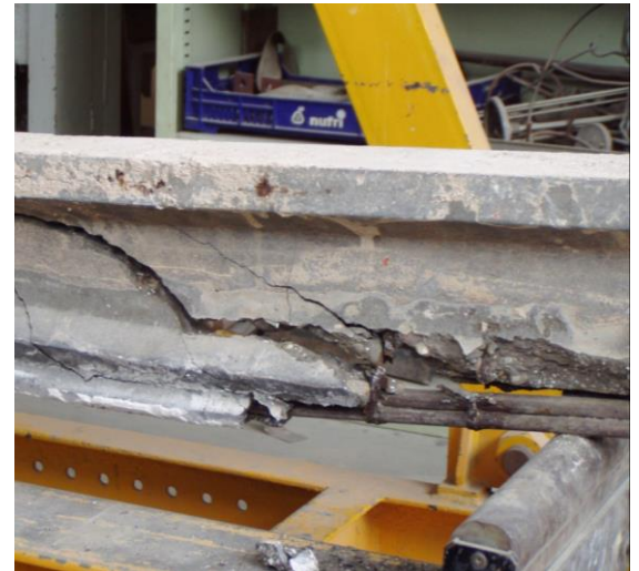
Assaig de flexió de biguetes de formigó al Laboratori
