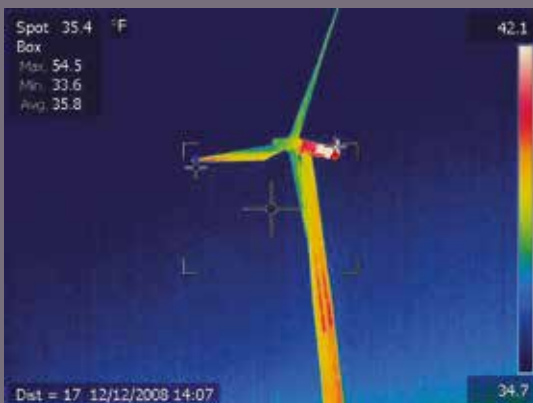
Termografía de una turbina eólica tomada desde el suelo.
