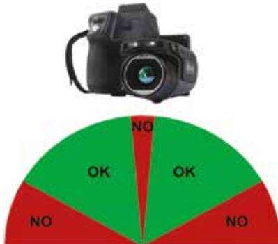
Ángulo de visión recomendado (verde) y a evitar (rojo) al realizar inspecciones termográficas.
